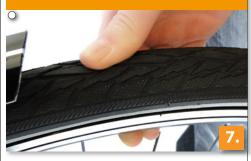
Prüfe mögliche Risse und Beschädigungen an Lauffläche und Mantelseiten
